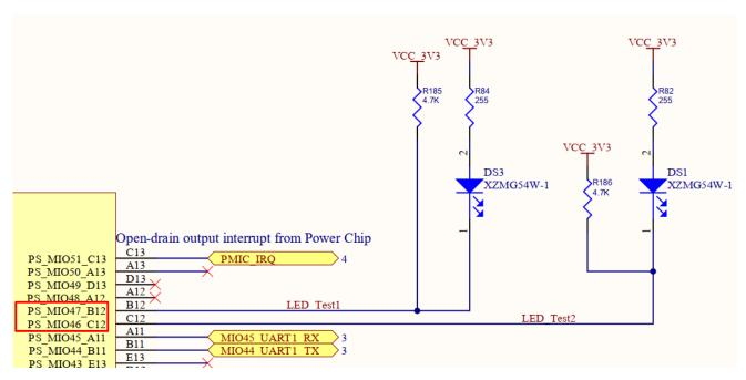
The pins are access at base\_gpio + offset, or 338 + 46 = 384 (LED DS1), or 338 + 47 = 385 (LED DS3).
