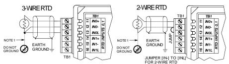
NOTE 1: DO NOT APPLY EARTH GROUND TO INPUT LEADS OR INPUT TERMINALS. EARTH GROUND SHOULD INSTEAD BE APPLIED AT THE INPUT LOGIC GROUND TERMINAL (GND AT TB3-33).
